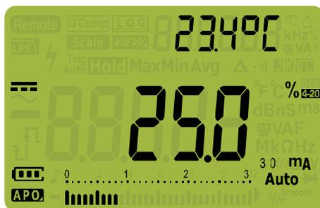
**Abbildung 2-34** 4-20 mA %-Skalaanzeige
