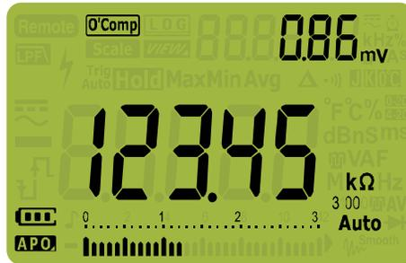
**Abbildung 2-17**Anzeige von Smart  $\Omega$  (mit Vorspannung)
