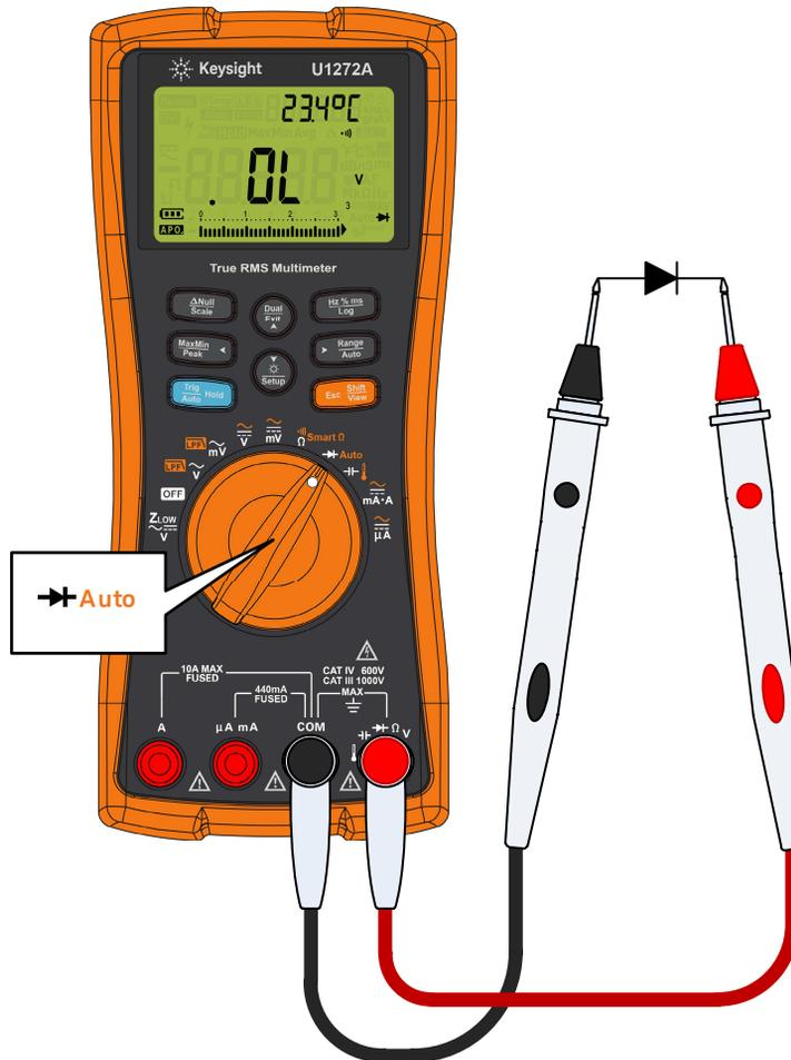
Abbildung 2-22 Testen der Sperrspannungs-Diode
