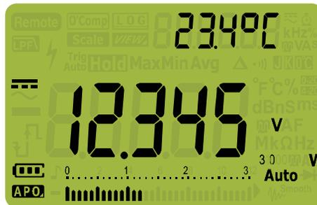
Abbildung 2-4 DC-Spannungsanzeige
