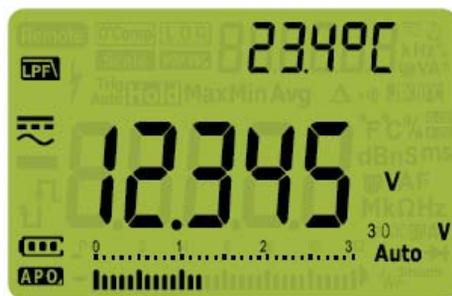
**Abbildung 2-8** Tiefpassfilterfunktion (LPF) für die Gleich- und Wechselspannungsmessung
