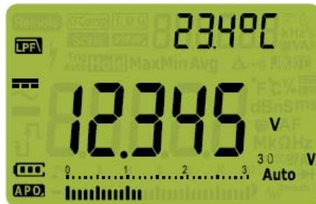
Abbildung 2-6 Filter für Gleichspannungsmessungen
