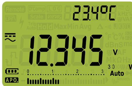
**Abbildung 2-7** AC+DC-Spannungsanzeige
