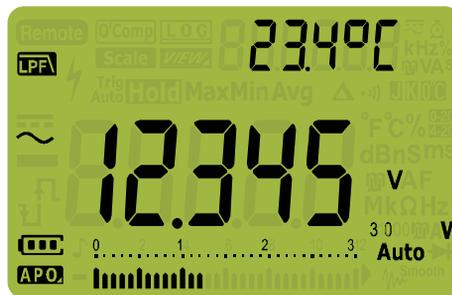
Abbildung 2-3 Ac-Spannung mit LPF-Anzeige
