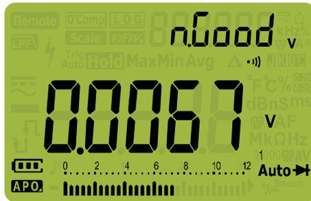
Abbildung 2-24 Anzeige für Autom. Diode - Status „nGood“
