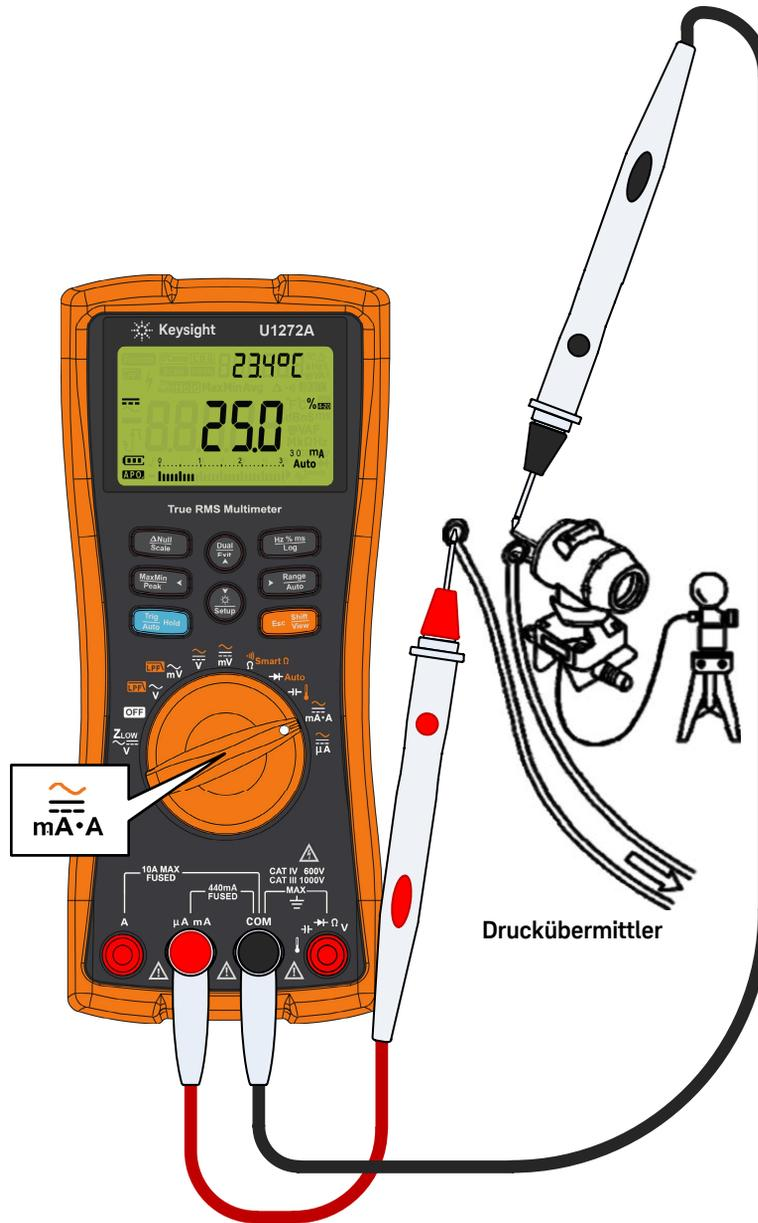
Abbildung 2-35 Messen der DC-Stromstärke mit der Funktion 4-20 mA %-Skala
