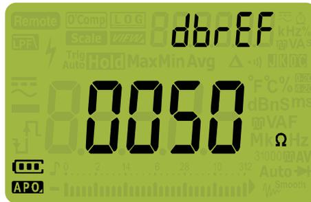
**Abbildung 4-7** db<sub>r</sub>EF-Anzeige
