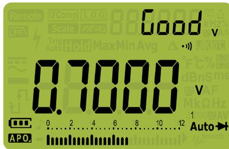
Abbildung 2-23 Anzeige für Autom. Diode - Status „Good“
