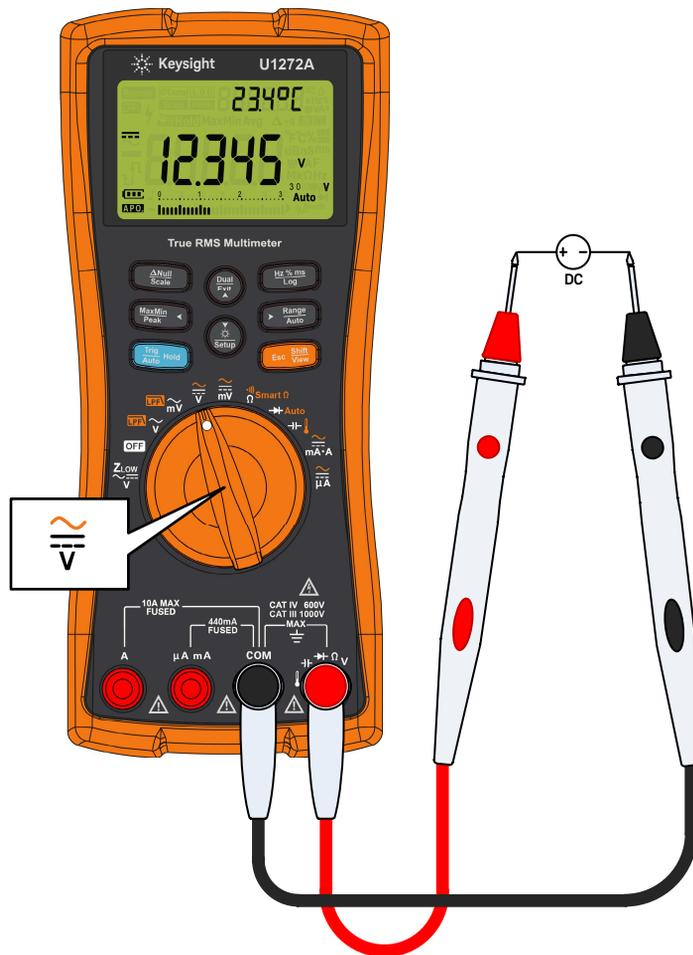
Abbildung 2-5 Messen der DC-Spannung
