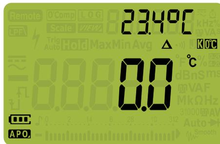
Abbildung 2-29 Temperaturmessungen ohne Umgebungskompensation
