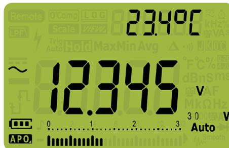
Abbildung 2-1 AC-Spannungsanzeige
