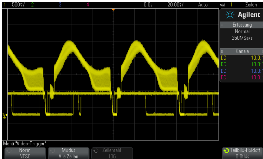
Abbildung 16 Triggerung auf alle Zeilen
