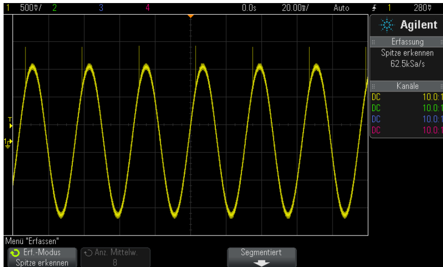
Abbildung 25 Sinus mit Störimpuls, Modus „Spitze erkennen“
