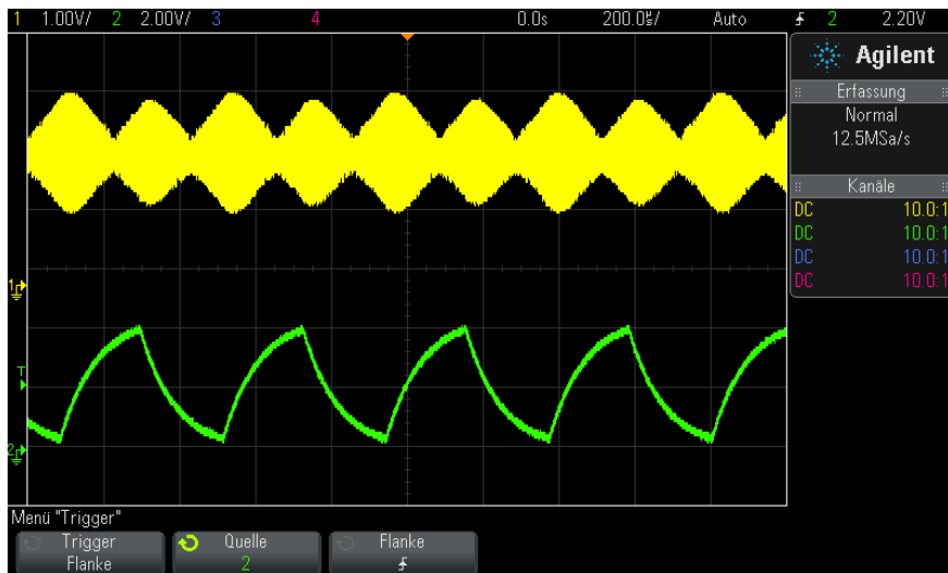
Abbildung 13 Amplitudenmodulation bei 100% Intensität
