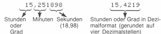
**Konvertieren zwischen Formaten.** Zeitangaben (in Stunden bzw. Hours, H) oder Winkelmaße (in Grad bzw. Degrees, D) können zwischen einer dezimalen Darstellung (H.h oder D.d) und einem Minuten-Sekunden Format (H.MMSSss oder D.MMSSss) umgerechnet werden, indem Sie →HR (nach Dezimalstunden) und →HMS (nach Stunden-Minuten-Sekunden) verwenden.
